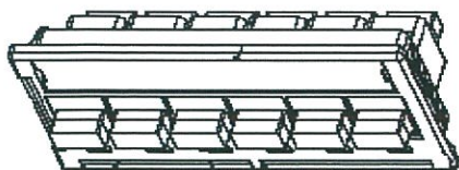
Rys.8 Moduł zatrzaskowy typu Quick-Fit 6xLC OM3
